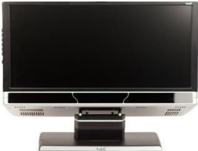
Figura 6: Rastreador Ocular Tobii TX-300
