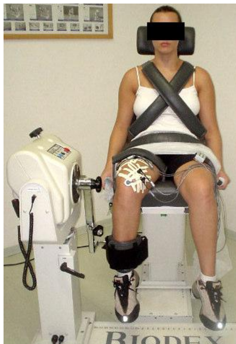
Figura 4.4: Dinamômetro isocinético Biodesx System 3. Ilustração do experimento, com os eletrodos posicionados nos pontos pré-definidos nos músculos RF, VL, VML e VMO. Fonte [49].
