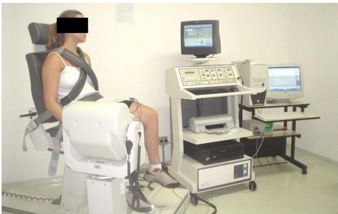
Figura 4.5: Ilustração do experimento. Durante o exercício realizado, o monitor do dinamômetro isocinético fornecia o feedback do torque que estava sendo gerado pelo voluntário, possibilitando o controle do experimento. Fonte [49].
