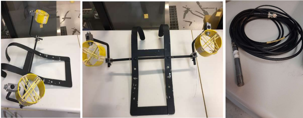
Figura 32 - Suporte duplo e microfones para simular uma aquisição binaural
