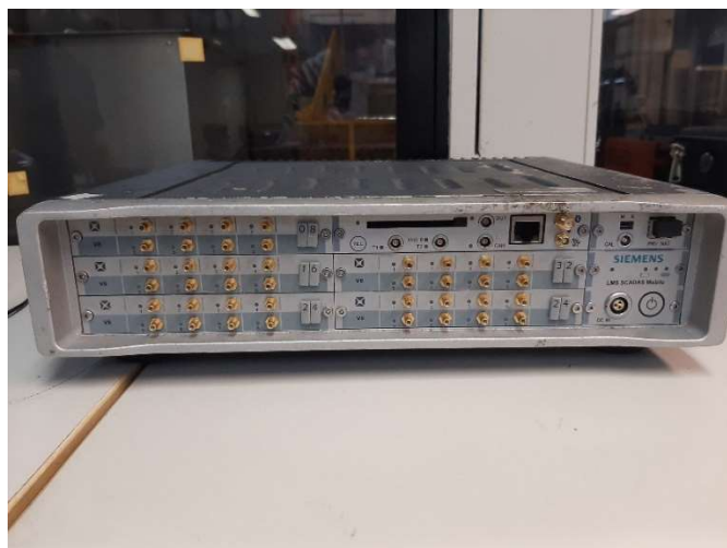
Figura 31 - Módulo de aquisição de sinais Siemens Scadas
