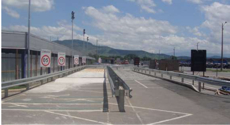
Figura 36 - Pista de teste utilizada para aquisição dos ruídos com diferentes pavimentos
