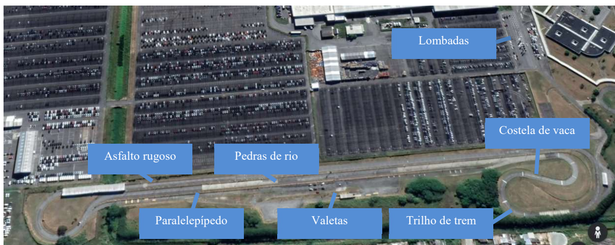
Figura 35 - Vista aérea da pista de teste em Porto Real usada para gravação dos ruídos
