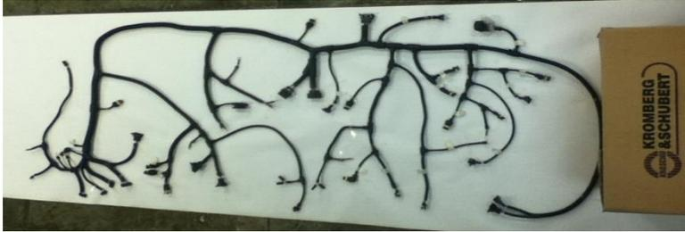
O chicote distribui energia elétrica e leva os sinais de sensores até os seus respectivos módulos, de forma segura. Antes dele ser manufaturado é feito um projeto onde leva-se em conta as cargas que devem
