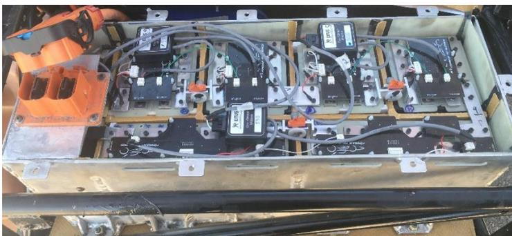
A bateria é essencial para que o carro possua um bom desempenho em pista, ela deve ser dimensionada conforme o consumo do motor e inversor, para que não falte energia durante as provas e também que não fique muito pesada. Deve ser também segura, com controle de temperatura e tensão, e boa isolamento elétrica. Por meio de software é feita a análise estrutural do container de baterias, assegurando uma boa fixação e resistência mecânica.
