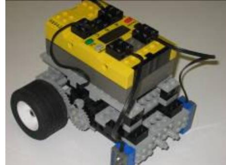
Para construirmos o robô utilizamos o *kit* de robótica da LEGO, *MindStorms For School*, que contém as mais variadas peças (engrenagens, vigas, blocos, pranchas, eixos, etc.), atuadores e sensores. O *kit* foi cedido pelo Colégio Anchieta para termos as condições de prepararmos o robô.
