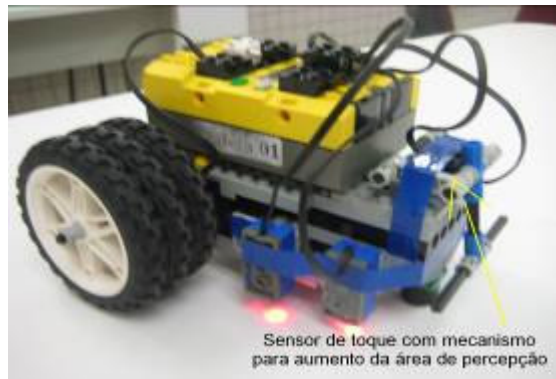
Figura 5: Mecanismo do sensor de toque.
