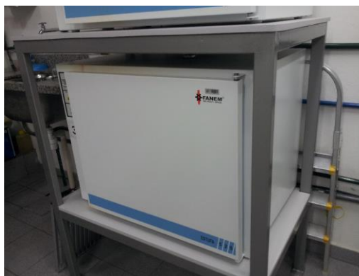
Figura 11: Forno utilizado para o tratamento térmico de envelhecimento artificial.
