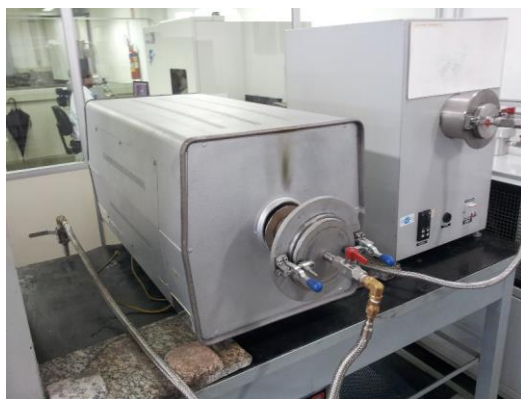
Figura 10: Forno tubular utilizado para o tratamento térmico de solubilização.
