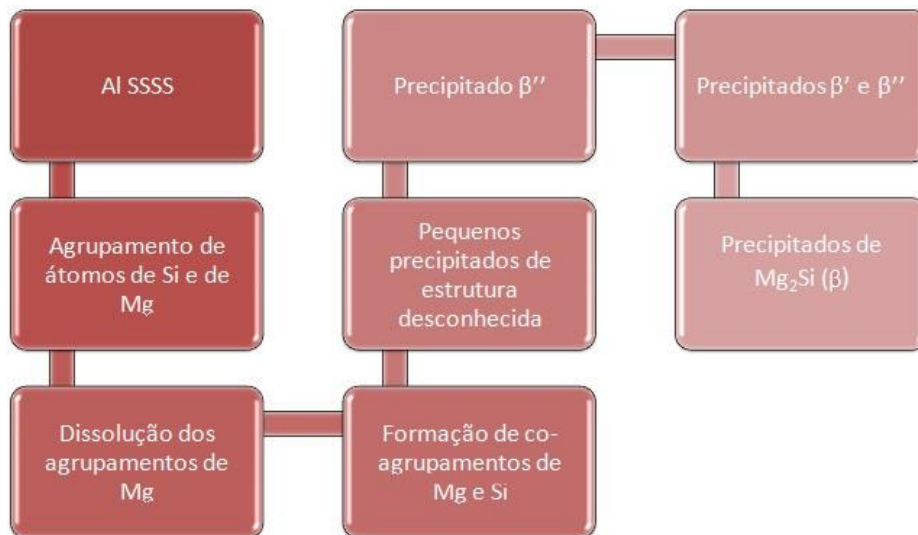
Figura 7: Sequência de precipitação das partículas de segunda fase em ligas de alumínio da família 6000.
