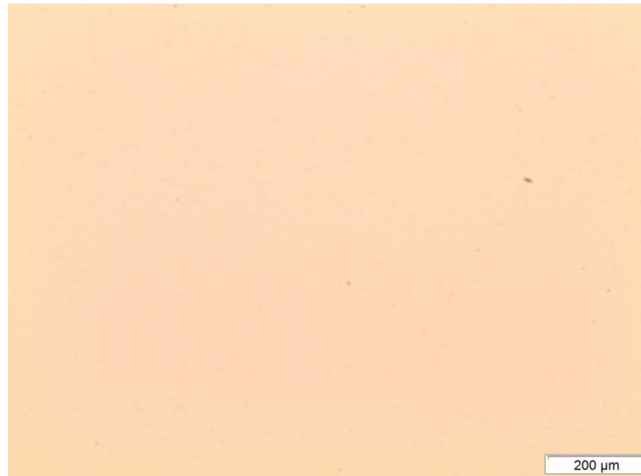
Figura 14: Micrografia sem ataque e polida da amostra envelhecida a 170°C por 9 minutos.
