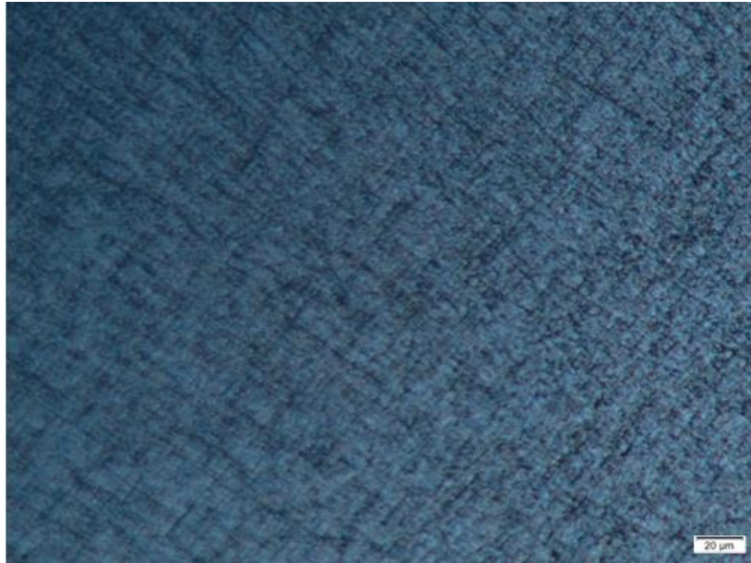
Figura 19: Micrografia após o ataque por imersão utilizando o reagente de Keller.
