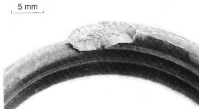
Figura 15: Fratura de uma mola por fadiga<sup>[8]</sup>.
