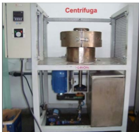
Figural - Representação da centrífuga laboratorial do Centro de Desenvolvimento de Materiais Metálicos da FEI (CDMatM – FEI).
