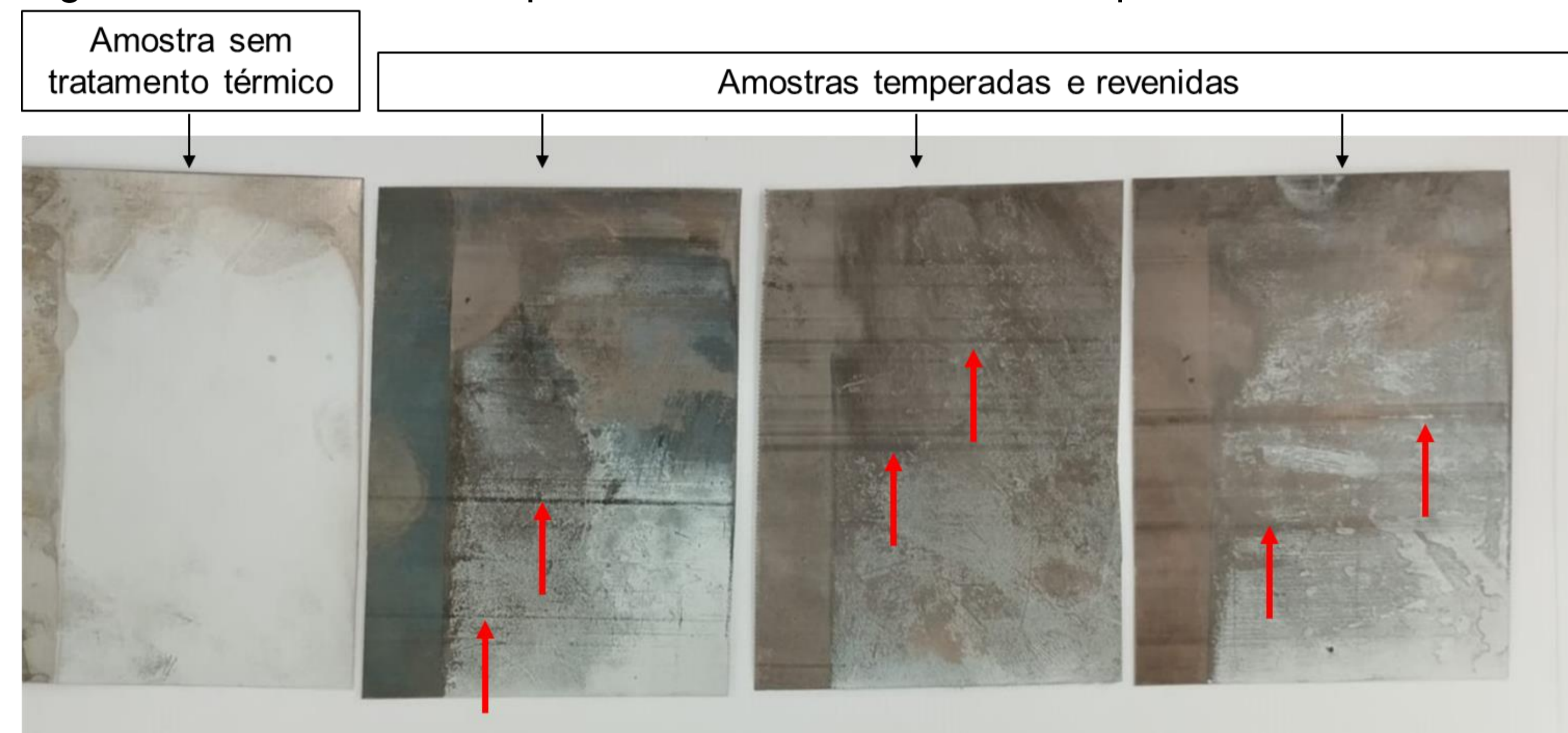
Figura 06 – Amostras temperada e revenida, revestidas por célula de Hull.
