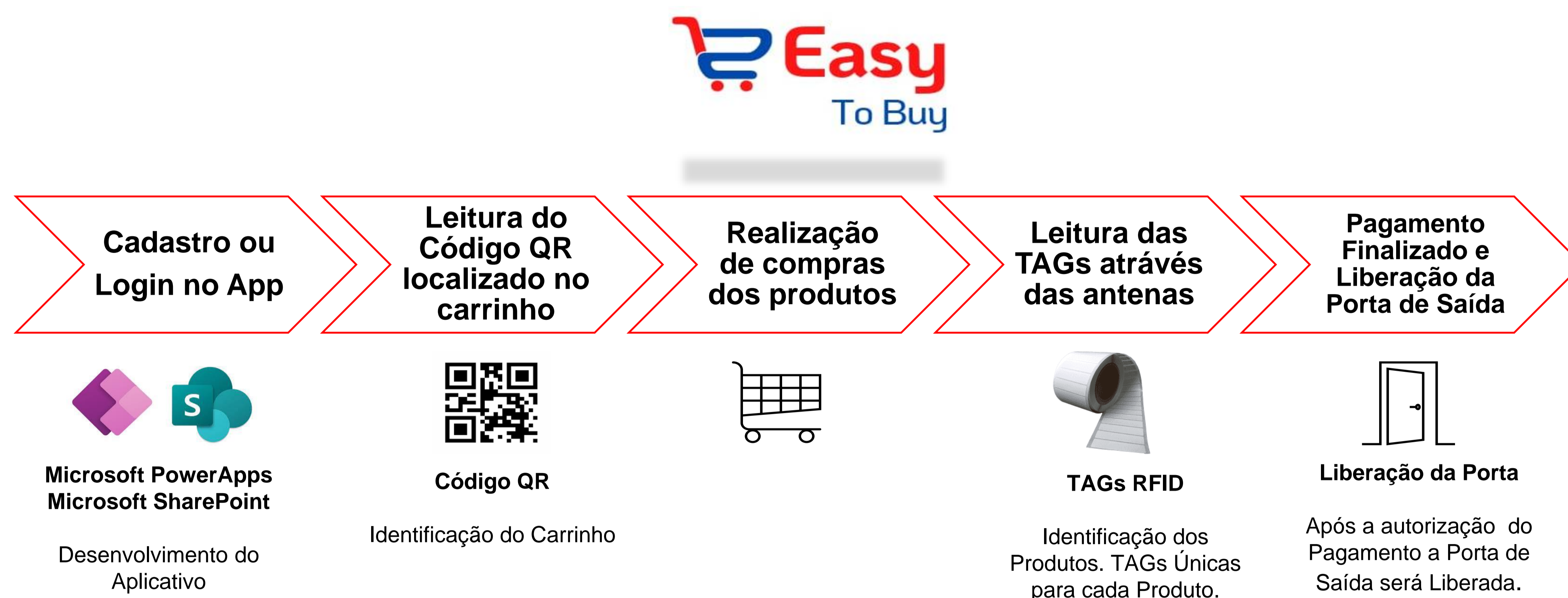
Fluxograma 1 – Etapas do processo de funcionamento do sistema
