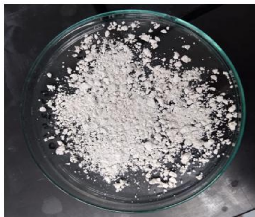
Figura 18 - Ácido tereftálico obtido pela reação com solução H 2 SO 4 14 M e aquecimento.
