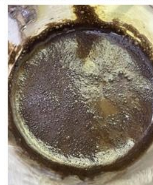
Figura 5 – Cátodo após formação das bolhas com a adição de 0,5 \text{ M} de ion de \text{Fe}^{2+}
