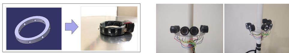
O sistema de comunicação funciona através de emissores e fotorreceptores infravermelhos, os emissores foram dispostos em uma pulseira utilizada pelo paciente e os fotorreceptores posicionados na haste. Os infravermelhos são sistemas bastante direcionais e por isso para aumentar a recepção do sinal foram utilizadas lentes colimadoras de 60° que foram colocadas em pares, criando um ângulo de abertura de 180° de recepção. Observe as figuras dos dispositivos implementados.
