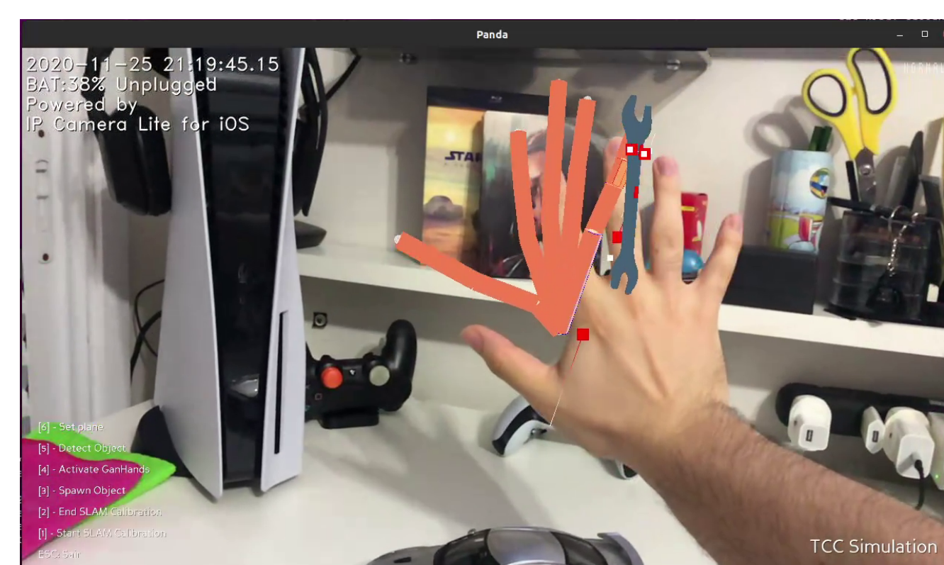
Figura 3 - Visualização da interação entre a malha da mão real e o objeto virtual, os modelos incluem uma chave inglesa e um carrinho. Quadrados vermelhos indicam contato da mão com o modelo virtual.
