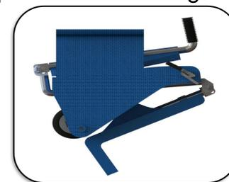
Para a validação da solução obtida, foi feita uma simulação utilizando uma força remota de 800N a uma distancia 200mm acima do assento no sentido vertical de forma a descrever o centro de gravidade de uma pessoa sentada.
