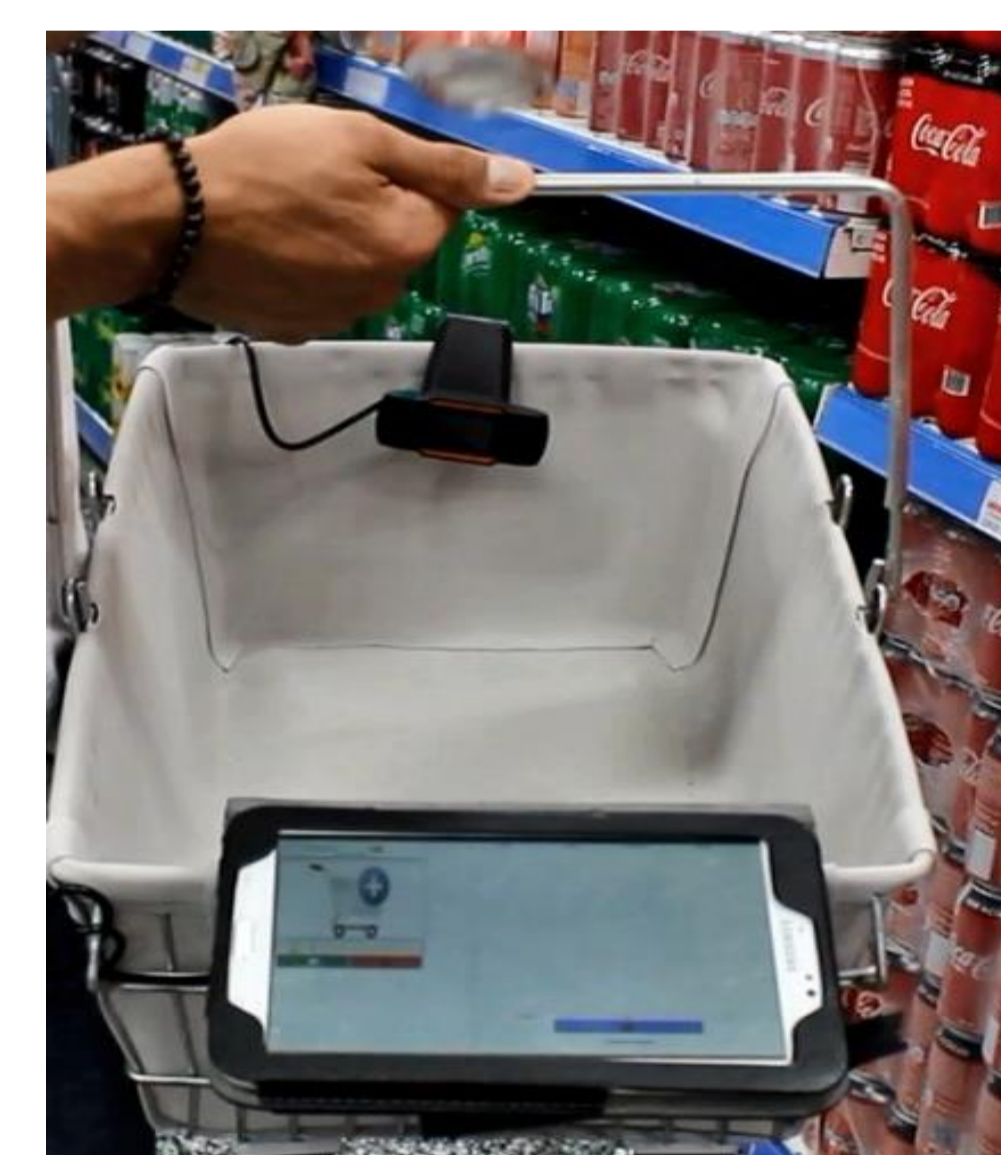
Figura 6 - Protótipo do IPCart implementado em uma cesta. Fonte: Autores.
