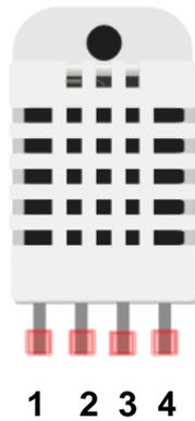
No sensor DHT temos quatro pinos: O de número 1 se refere a entrada de força, o 2 a saída digital de dados, o 3 não é utilizado, e o 4 será a saída para o fio terra.
