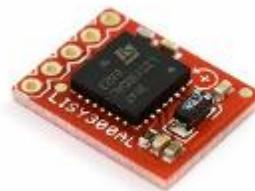
*Figura 14: Giroscópio Digital LISY300AL*
