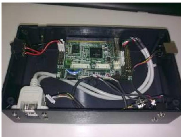
*Figura 7: Montagem em jiga da placa RoBoard*
