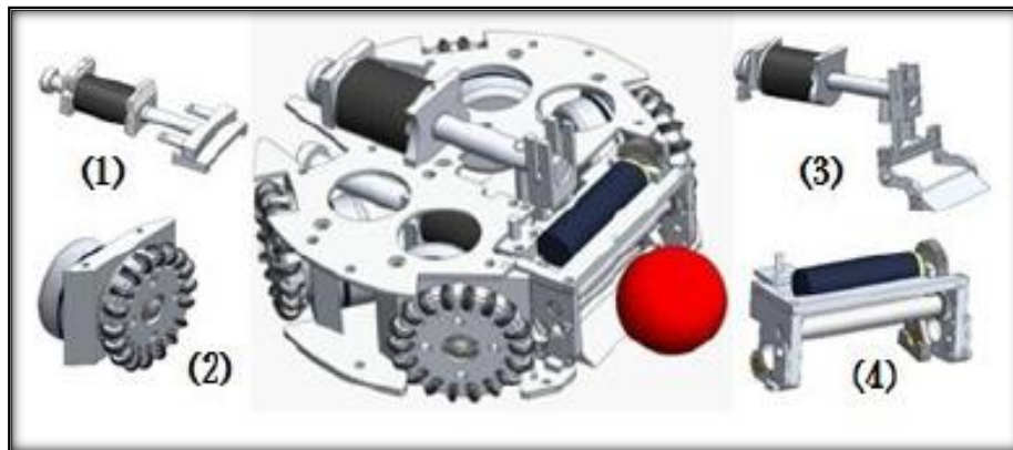
Figura 8 - Estrutura Mecânica: (1) Mecanismo de chute direto; (2) Rodas omnidirecionais; (3) Mecanismo de chute aéreo; (4) Sistema de drible.
