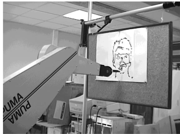
Figura 1. O manipulador PUMA 560 esboçando uma caricatura.
