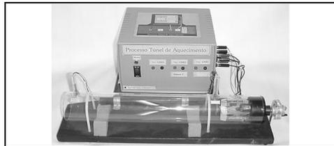
Figura 10. Processo túnel de aquecimento
