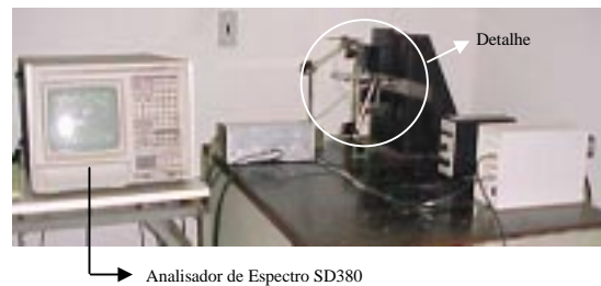
Figura 11. Montagem da instrumentação da bancada da viga vibratória para caracterização dos controladores na frequência.
