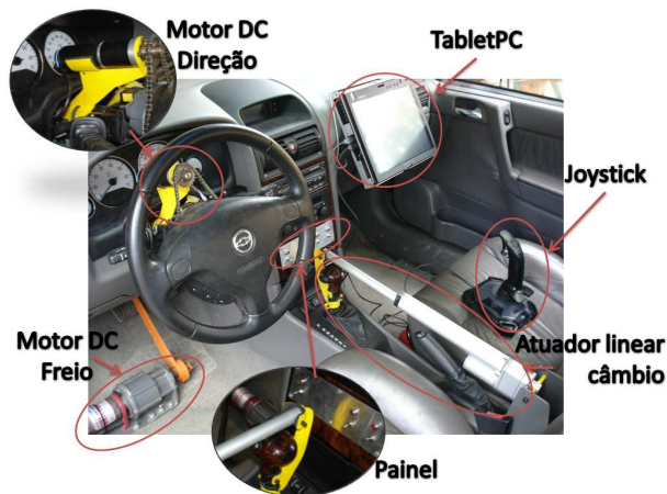
Figura 1: Visão interna do veículo com os elementos de atuação, o painel chaves, o TabletPC e o joystick usado para testes.
