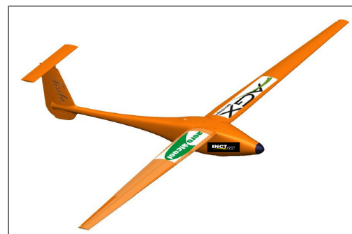
Figura 4: Tiriba - aeronave não tripulada de pequena dimensão
