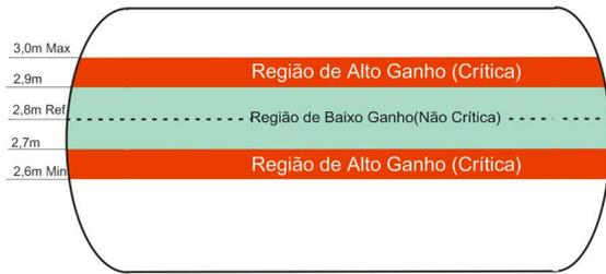
Figura 2. Diagrama do Vaso Separador.
