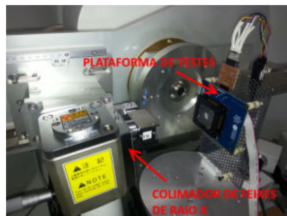
Figure 1: Detail of the test platform under the x-ray beam. Source: Benfica, J. D. (2015). Plataforma para testes e qualificação de dispositivos reconfiguráveis e sistemas em chip, submetidos aos efeitos combinados da interferência eletromagnética e da radiação ionizante (Doctoral dissertation, Universidade Federal de Santa Catarina). Retrieved from https://repositorio.ufsc.br/handle/123456789/169285
