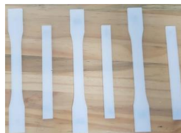
Figura 3 - Corpos de prova de tração e impacto.
