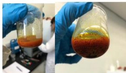
Figura 2 – Início da reação da acetofenona com ácido bromídrico, em etanol e peróxido de hidrogênio.
