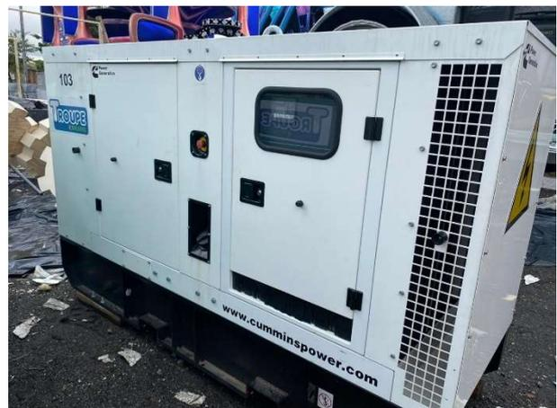
Figura 5 – Gerador elétrico Cummins C110D2R.
