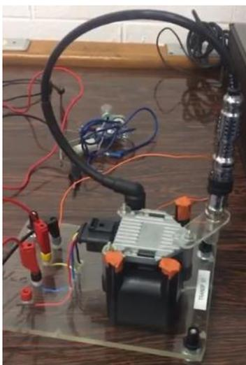
Figura 3 – Transformador e bobina de ignição fixados numa base de acrílico.
