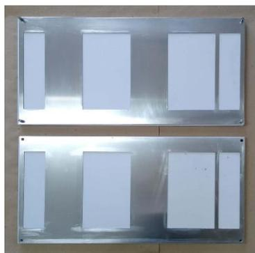
Figura 4 - Gabarito para obtenção dos cps
