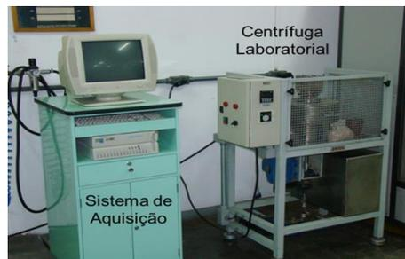
Figura 1-Centrífuga Laboratorial e sistema de aquisição-CDMatM-FEI
