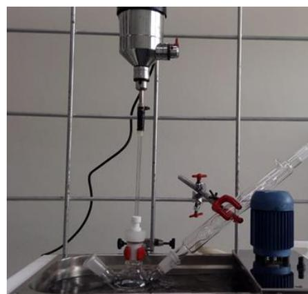
Figura 2 – Equipamentos empregados na produção de biodiesel utilizando a agitador mecânico.
