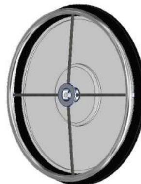
Figura 1: Desenho do projeto proposto com aro conectado à roda por uma estrutura tubular central.
