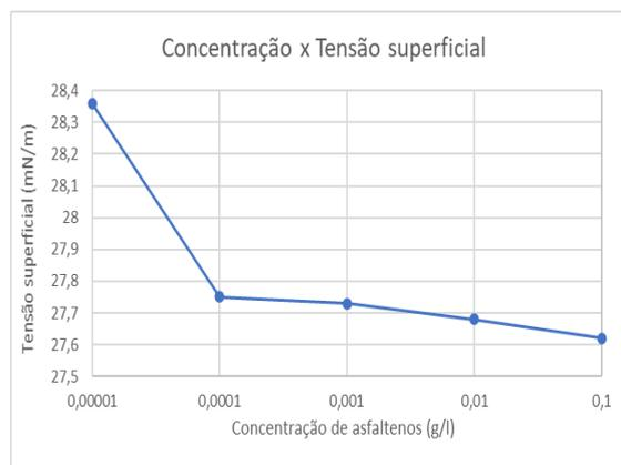
Figura III – Gráfico de concentração por tensão.
