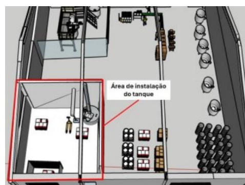
Figura 3. Layout da instalação do tanque de processo.
