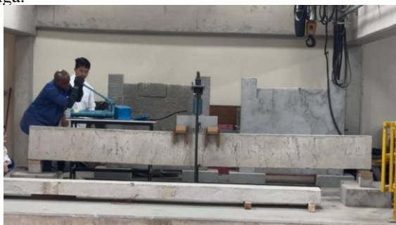
Figura 1. Instante de ruptura da viga
