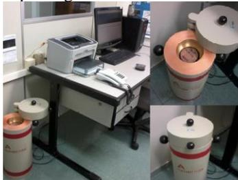
Figura 2 – Equipamentos do LAFIR, utilizados para a coleta de dados. O detector se encontra dentro da blindagem de chumbo e a aquisição é feita automaticamente com interface ao computador.
