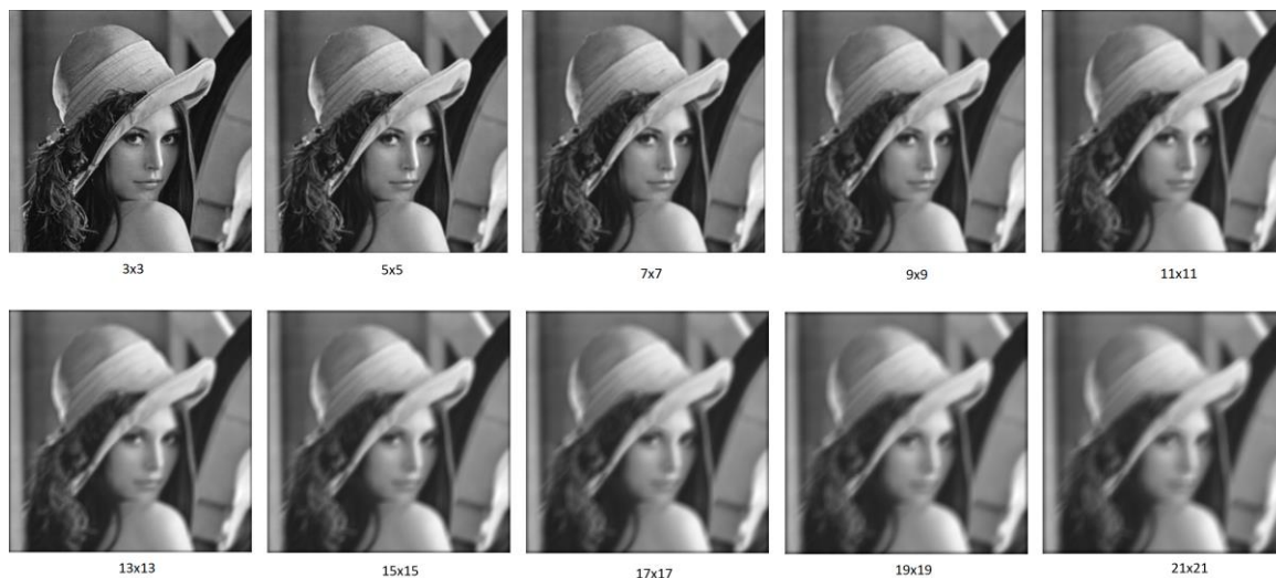
Fig 2: Filtro q-Gabor com q=2 , k=1 , u = v = 0.04 , P = 0 , X_0 = Y_0 = 0 , a = b = 0.075 , x = y = 0 e o janelamento variando de 3 a 21
