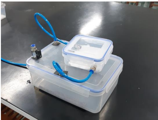
Figura 2 – Câmara de carbonatação com o cloreto de sódio em outro recipiente.
