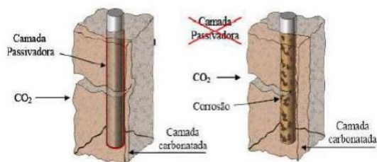
Figura 1 – Representação: despassivação da armadura.
