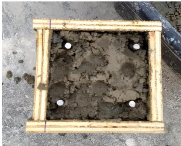
Figura 1 – Disposição do aço no Corpo de prova
