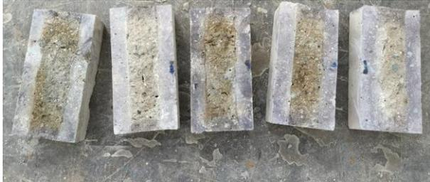
Figura 2 – Corpos de Prova ensaiados para íons de cloreto
