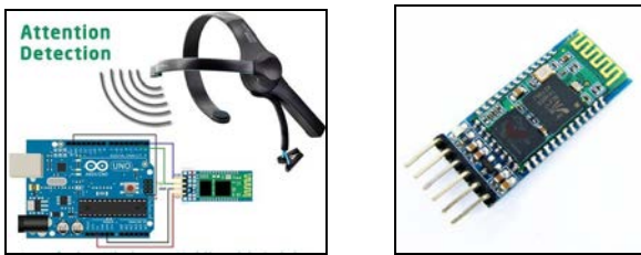
Figura 3 – Estrutura de ligação do módulo HC-05 com o Arduino e o Mindwave.
