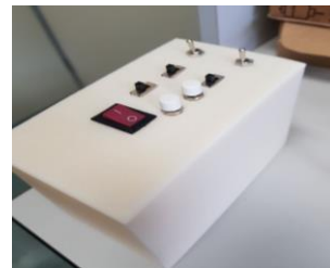
Figura 2 – Foto por cima da caixa de controle e estimulação montada.
