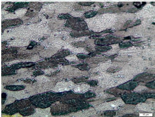
Figura 2 - Micrografias da liga criolaminada e (a) envelhecida artificialmente a 200 °C e (b) envelhecida naturalmente.
