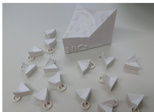
Figure 6: Ternários após impressão 3d em ABS.
