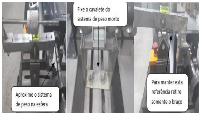
Figura 4 Sequência para realizar ensaio no tribômetro.
