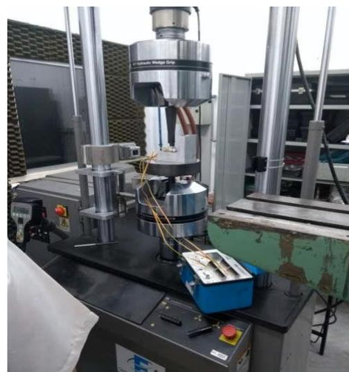
Figura 2 – Calibração da célula de carga na MTS.
