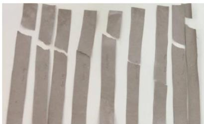
Figura 3 – Amostras após ruptura
